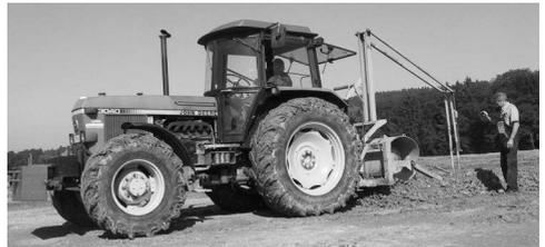
Mit der lasergesteuerten Grabenfräse ermöglicht Niklaus Lüthi die präzise Verlegung der Sickerleitungen bei der Gärtnerei
